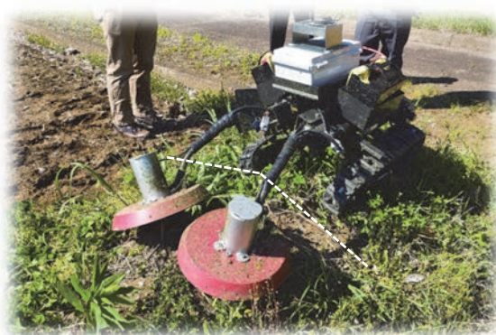
図2 三角畦畔に対応した試作ラジコン式草刈機
