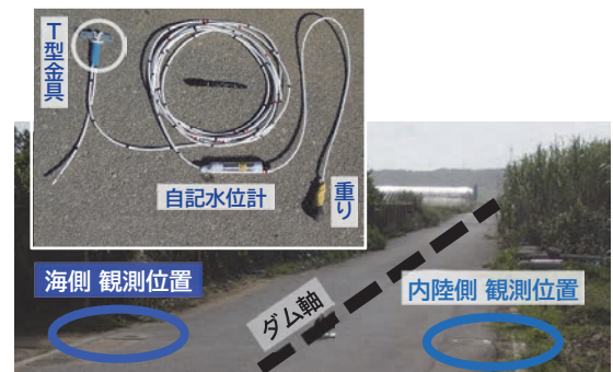
自記水位計の設置方法と観測配置の例
