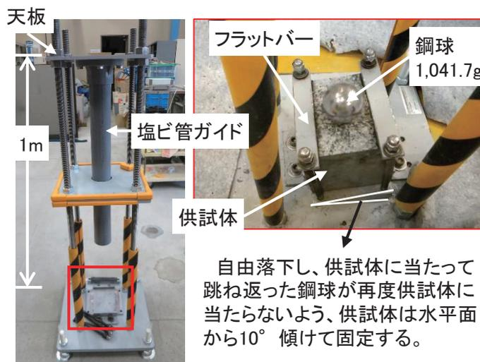
図2 鋼球落下式衝撃摩耗試験装置
