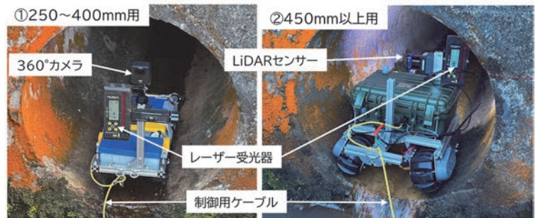
図1 底樋点検装置（下流から見た写真）
