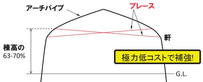
棟高の70%程度の箇所にブレースを設置すると、パイプハウスの耐雪強度が最大で3倍程度増加します。
