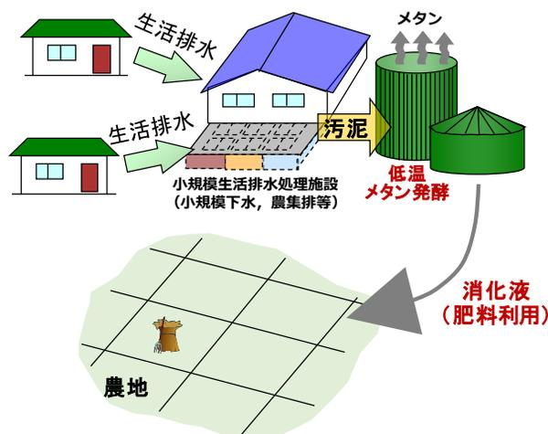
図1 エネルギー効率向上やコスト削減が期待される污泥のメタン発酵システム
