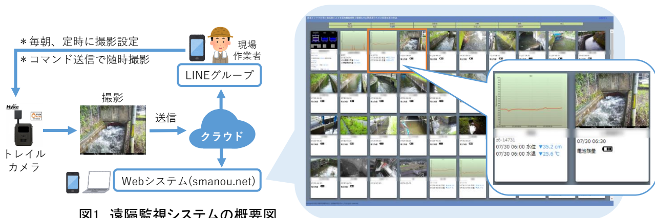
図1 遠隔監視システムの概要図
