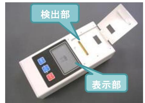
図2 携帯型測定装置の外観
