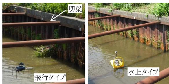
図3 鋼矢板画像取得方法の例
