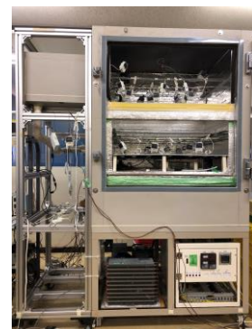
図1 熱貫流係数測定装置の模式図と実物
