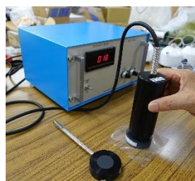
図1 熱貫流係数測定装置の模式図と実物
