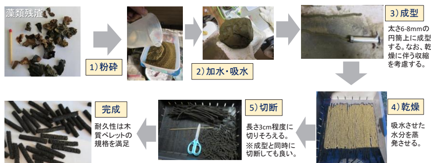
図2 考案した藻類残渣ペレット化技術
