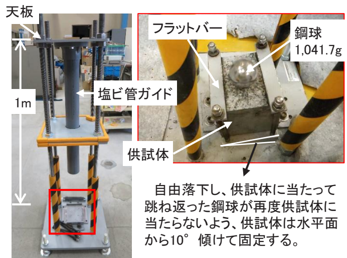
図2 鋼球落下式衝撃摩耗試験装置
