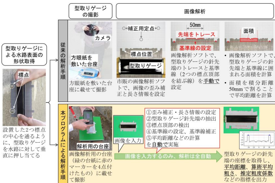
図1 摩耗量の測定原理
