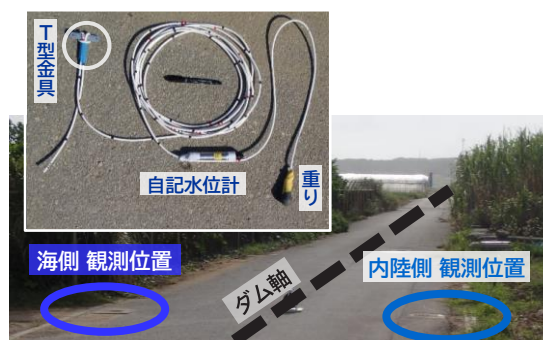
自記水位計の設置方法と観測配置の例
