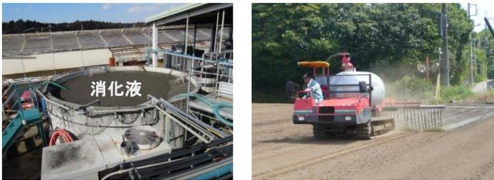
図1 貯留中のメタン発酵消化液(左), 消化液の散布様子(右)
