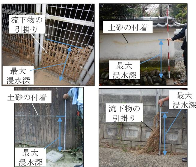
図1 決壊ため池における痕跡最大浸水深調査箇所
