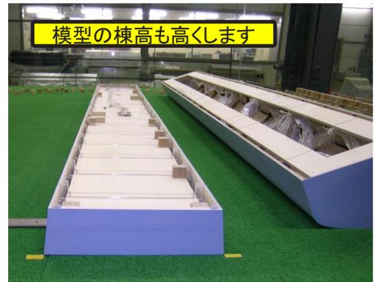
従来のパイプハウス(棟高3.16m)に対して、棟高を0.25, 1, 2m高としたパイプハウスを対象に、風圧力分布を風洞実験で求めました。
