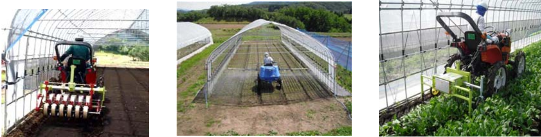
図1 乗用管理機及び6条は種機(左) ブームスプレーヤー(中) 根切機(右)
