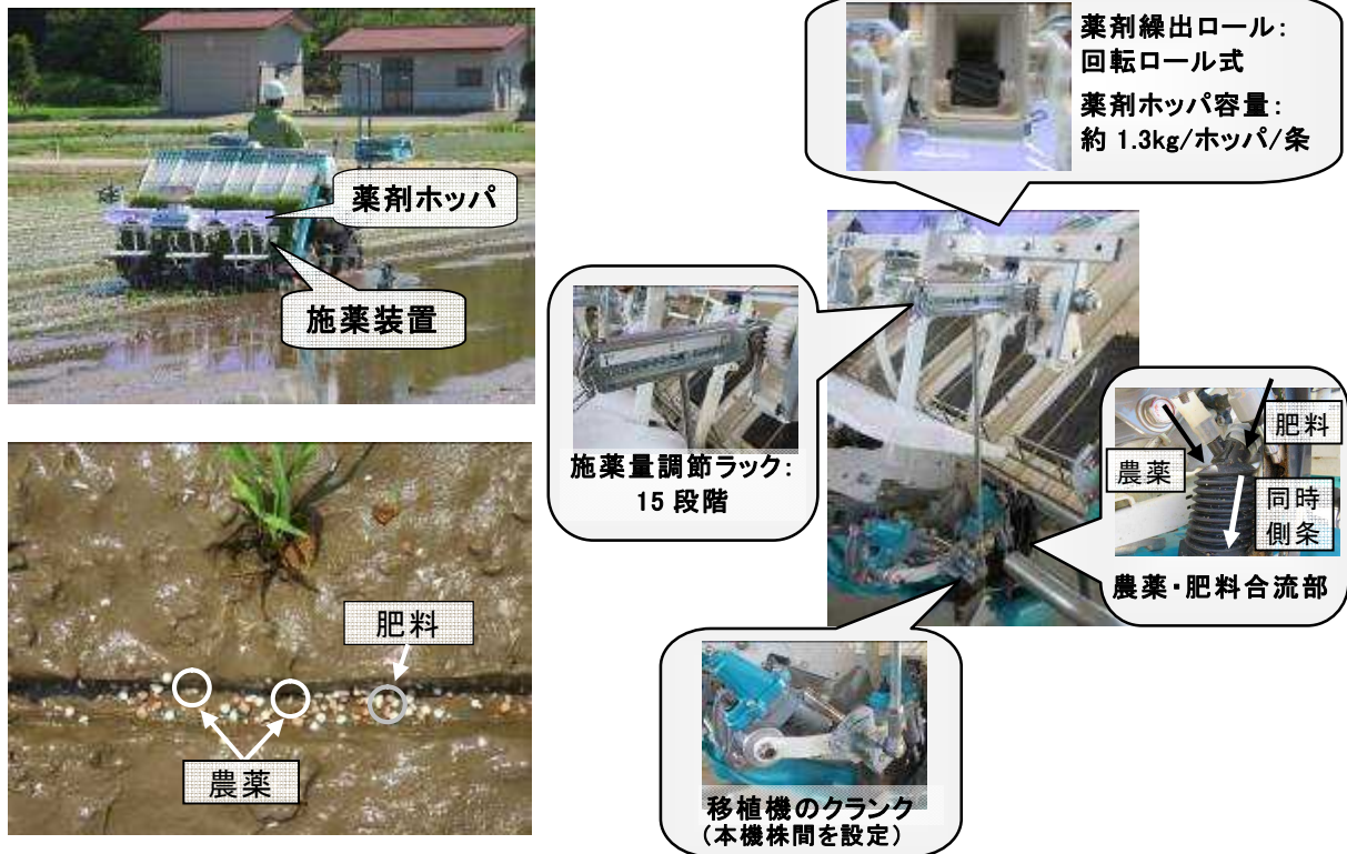
図1 開発した側条施薬装置と施薬の状況(左下写真は施薬条が覆土されていない状態で撮影)
