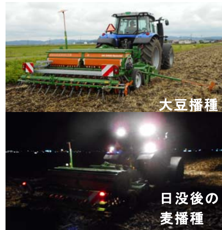
図2 GNSS自動操舵による整地・播種播種同時作業
