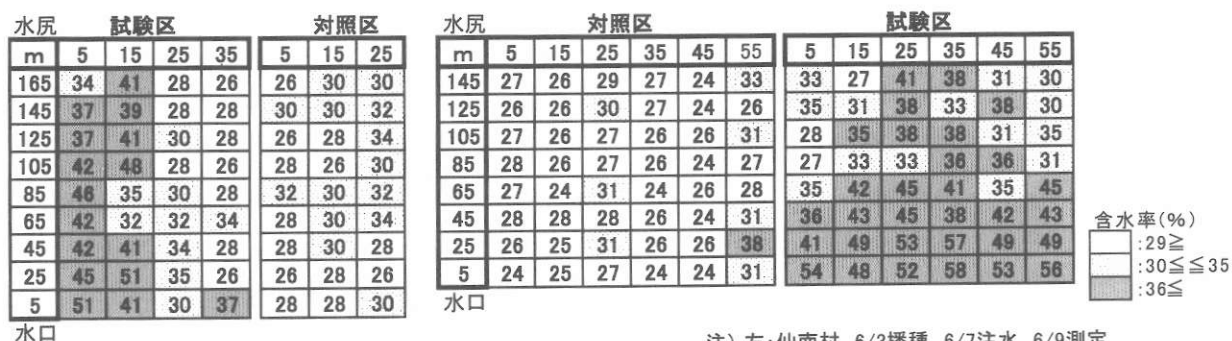
図2 播種時の注水後圃場の地中0-10cmの含水率分布 (左:仙南村、右:横手市)
