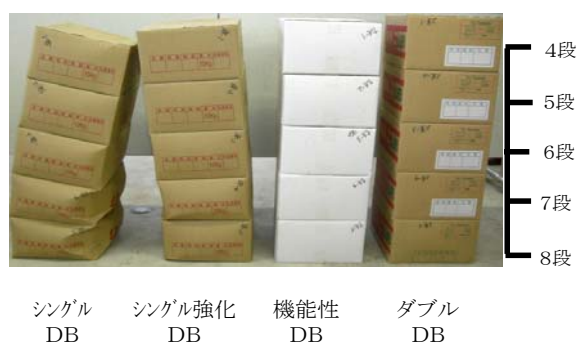
図3 2℃4週間貯蔵後の段ボール箱変形の状況
