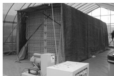
図1 実規模「シート乾燥」外観 写真手前の加温機で熱した温風を奥に取り付けたファンでハウス外へ排気。
