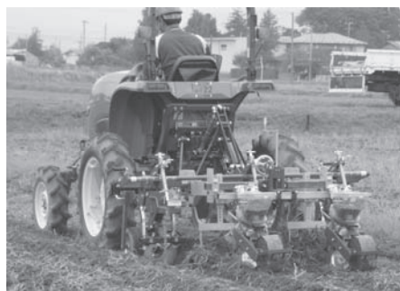
図 1 播種機を装着したディスク式除草機による播種作業（ディスク式畦立て播種）
