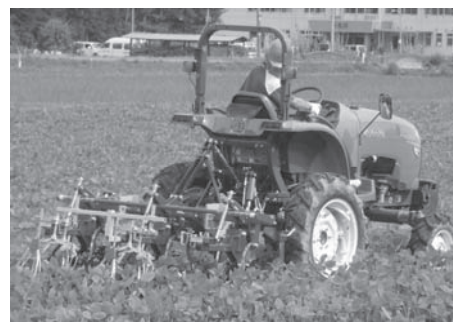
図 2 レーキを装着したディスク式除草機(改良型ディスク式除草機)による中耕培土作業
