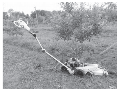
オフセット式 市販法面用歩行型草刈機に オフセット部追加 機関出力: 1.7kW 刈幅: 300mm + 210mm 総刈幅約 460mm 機体質量: 45kg 作業速度: 0.41m/s、0.31m/s (2段変速)
