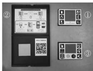
図2 供試した標準反射板3種類（①Airinov②MicaSense③Parrot）
