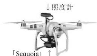
図1 供試した「Sequoia」搭載UAV（ファントム3）
