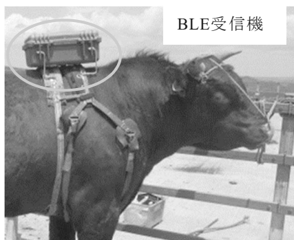
図2 種雄牛へのBLE受信機の取付
