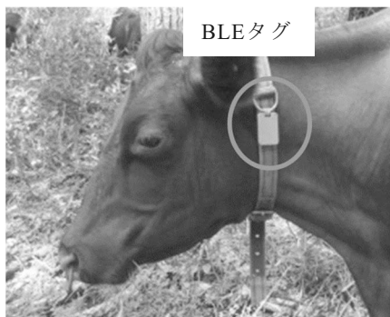
図1 繁殖雌牛へのBLEタグの取付
