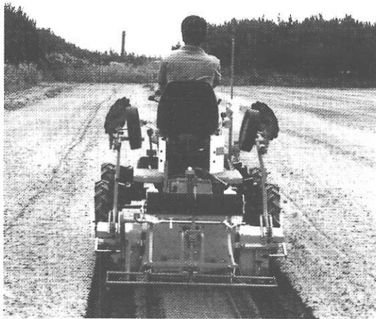
写真-1 乗用管理機での機械は種作業
