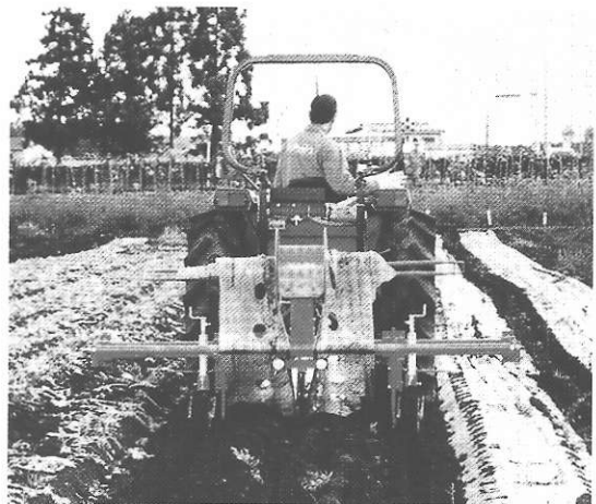
写真-3 マルチ回収機での回収作業 フレーム装着台車
