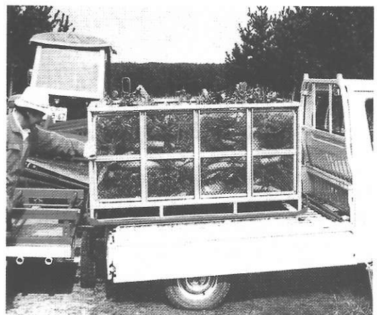
写真-5 移動用フレームで人力でコンテナ をトラックに搬出
