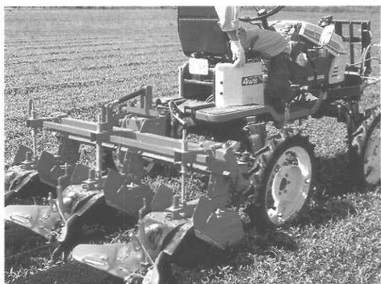
写真三 管理ピークルによる中耕・除草作業
