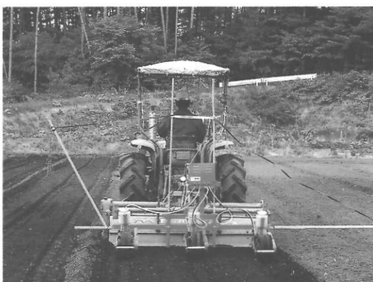
写真二 真空播種機による播種状況
