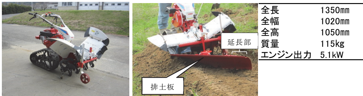
図1 作業道造成機（左：本体、中：排土板（山側延長）、右：諸元）
