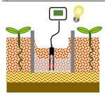
➤ 翌日、23~25時間後の間に体積含水率の値を記録する。 これが「飽和状態に達して後に排水開始して24時間後のの体積含水率」の 値である。
