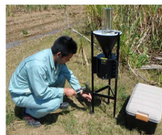
設置はハンマーで鉄杭を打ち込みます。
