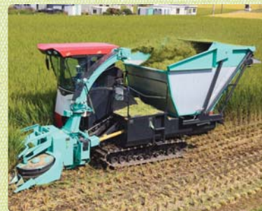
(株)タカキタ SMW5200 全長6.8m 全幅2.25m 全高2.8m 重量4.65トン
