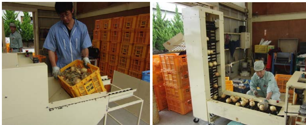
図2 2名1組での作業（左：供給部へのタマネギの補給、右：選別部での作業）
