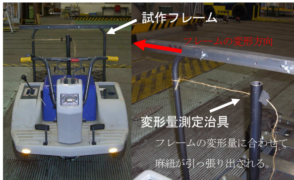
図2 試作フレームを装着した農用運搬車と変形量測定
