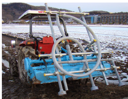
図 2 3列ノズルをトラクターに取り付けた状況
