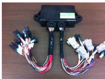
図3 ケースに格納し、ハーネスを接続した AgriBusBoard32
