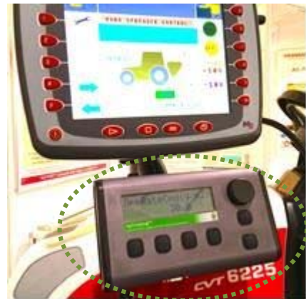
図2 開発したソフトウェアライブラリを適用した VT への画面表示例と共通化リモートコントローラ (点線内)
