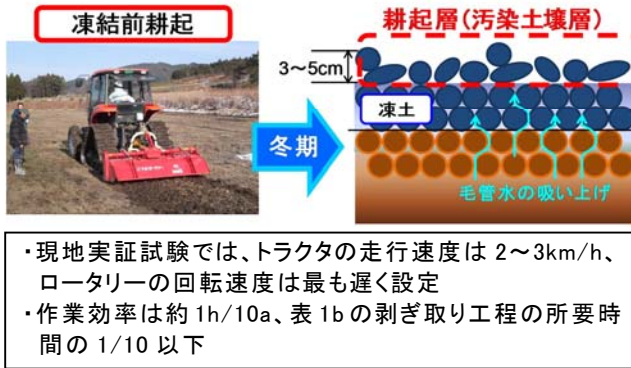
図1 冬期の剥ぎ取り工法(新工法)の概要
