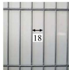
図1 スズメの侵入を防ぐことができる網目サイズと計測方法 注：値はピッチではなく内径（空間の幅）で、例えば溶接金網では20mmピッチの金網で内径約18mmとなる。
