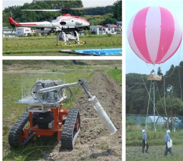
図2 移動体に搭載した測定状況 (右: 気球, 左上段: 無人ヘリ, 左下段: ラジコン移動車)
