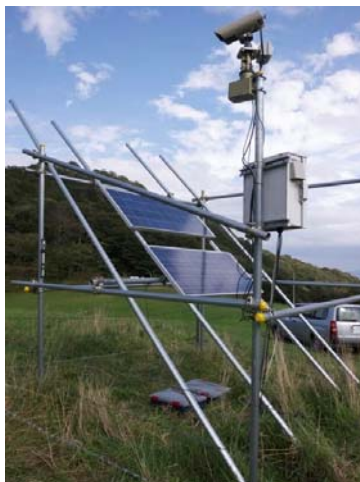
図2 太陽光パネル電源で牧草地に設置した熱画像カメラ搭載型のモニタリングシステムと受像画面(ニホンジカ)
