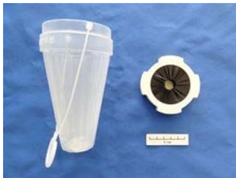
図1 花冠取り器（市販モデル）の構成 左：浸漬用カップ、右：ブラシ部
