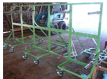
図3 トンネル換気量測定装置
