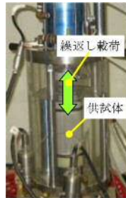
(a) 液状化試験状況 (b) 細粒分を含む砂質土の液状化による変形挙動
