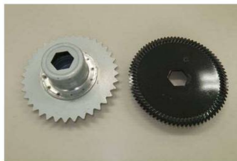
図1 排わらかットの模式図, ロータ配置間隔, 並びにロータ(掻き込みホイール)と回転刃の外観
