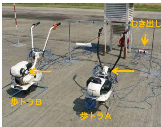
図1 ポンベ表面温度の測定風景 (←: ポンベの位置) (右)
