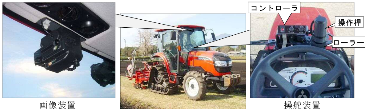
図 1 自動操舵装置の全体構成
