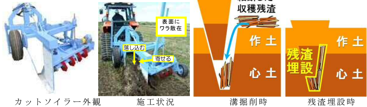
図1 カットソイラーの外観と施工方法
