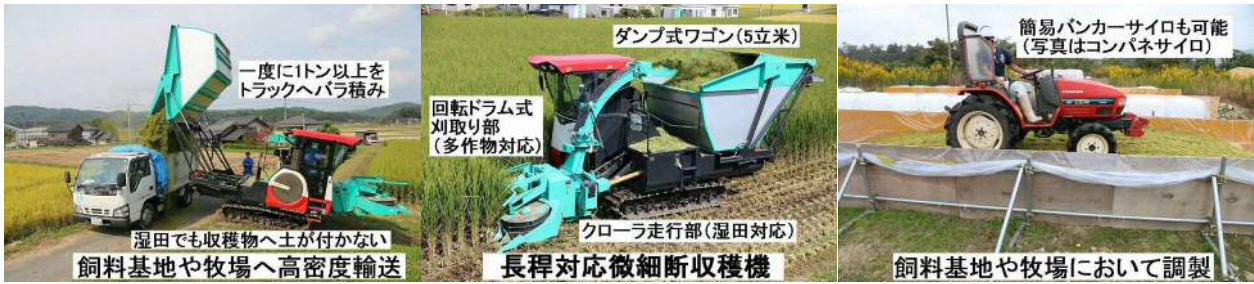
図1 微細断収穫・調製体系はバラ積み輸送して飼料基地や牧場で調製する 長程対応微細断収穫機(ワゴンタイプ)は平成28年6月市販予定
