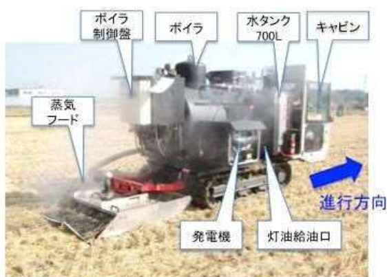
図1 蒸気処理防除機 JJ7の外観 車体左前面に用水給水用の水中ポンプがある。
