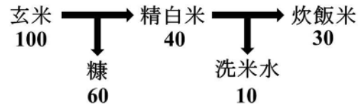
図1 玄米から精白米の炊飯米までにおける玄米の放射性セシウム量を100とした場合の分配割合 (%)
