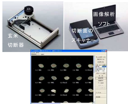
図4 市販された測定装置(上)と測定画面(下)
