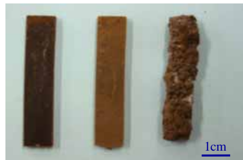
図2 土壤中(20一定)で1ヶ月経過後の生分解性素材の分解状況
