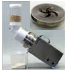
図2 低温製粉装置と金属臼 (CGM-100S、千穂田精衡)
