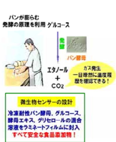
図 1 微生物センサーの原理と構成成分
