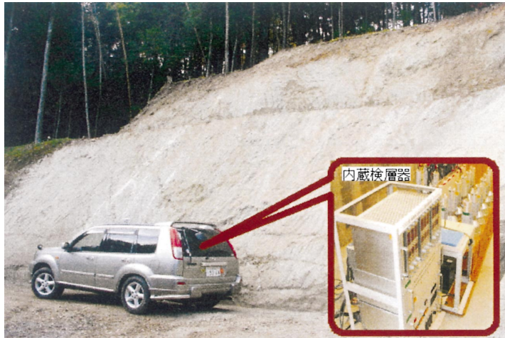
図2 車載型放射能探査装置での測定状況
