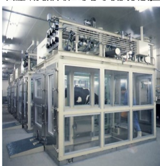
図2 ウシ用呼吸試験装置による精密なメタン産生量測定 一般的な牛と比較して約2割メタン産生量の少ない個体が見出された。これらの低メタン産生牛では第一胃内容液中のプロピオン酸が高濃度であることが確認された。
