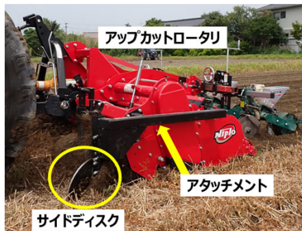
図1 ディスク式高速一工程播種法の外観（左）と概略図（右） サイドディスクをアップカッターロータリに取り付けるだけのシンプルな構造。
