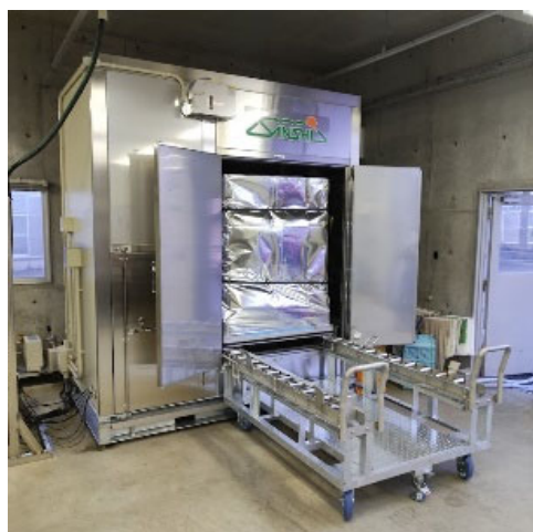
写真 500kg処理可能な基腐病用蒸熱処理装置
