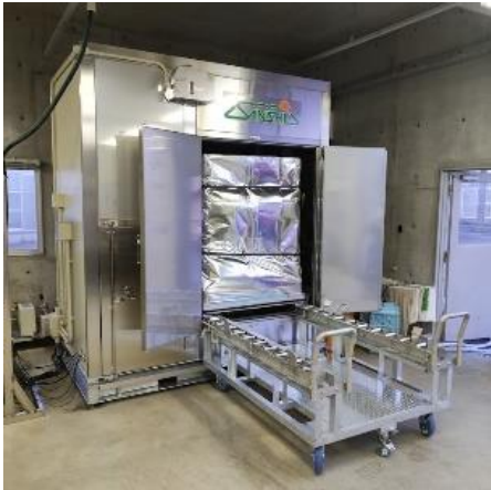
写真 480kg処理可能な基腐病用蒸熱処理装置
