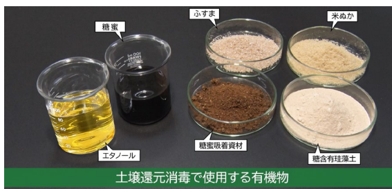
図1 土壌還元消毒で使用する有機物 土壌の深層まで還元消毒するためには、主に液体の有機物である「低濃度エタノール」や「糖蜜」が利用されてきた。新資材の「糖含有珪藻土」や「糖蜜吸着資材」は、糖を含む灌漑水が深層(深さ60cm程度)まで浸透して還元消毒効果を発揮。
