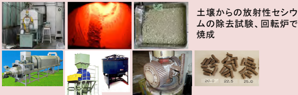
作物残さ・雑草等の乾燥、粉碎、混合、成型によるペレット化による減容化
