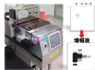
自動化異常蛋白質増幅装置(市販品)と試験管内で増幅した異常プリオン蛋白質。検出感度は動物接種の100万倍以上。プリオンの安全性評価に応用した。
