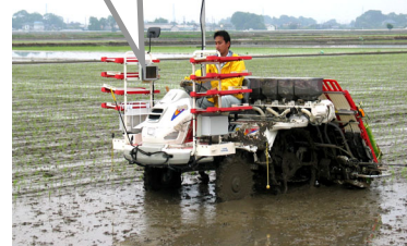
可変施肥装置を搭載した側条施肥田植機
