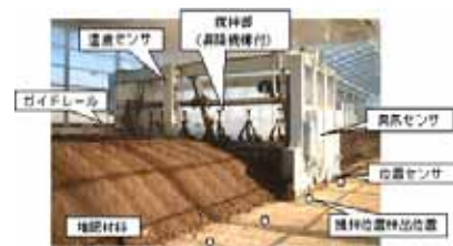
品質管理制御システムを搭載した堆肥自動攪拌装置
