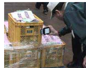
ICタグの読み取りによる野菜の流通履歴の記録
