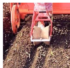
図1. 山形鎮圧輪による鎮圧
