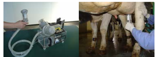
開発した乳頭清拭装置とその使用状況
