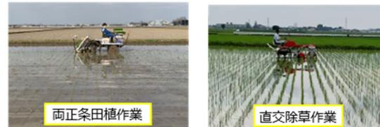
縦横に等間隔に移植した両正条植え水稻ほ場で高能率水田除草機を利用した直交除草により、除草率80%以上を達成
